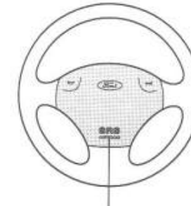
Supplementary Restraint System (doplňkový zadržovací systém)
